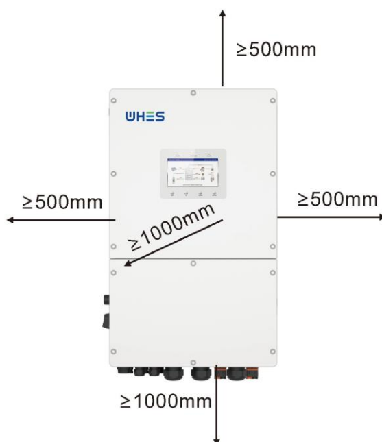
Figure 3.5 Dégagements pour le montage de l'onduleur
